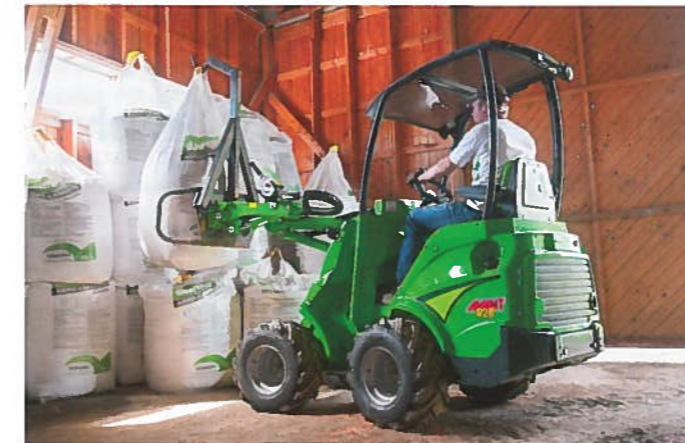
Durch die große Hubkraft, das horizontal starre Knickgelenk, dem Teleskophubarm und die kompakten Abmessungen, sind beide Modelle bestens für den Einsatz in schmalen Gängen und engen Innenräumen geeignet. Foto: Avant Tecno
