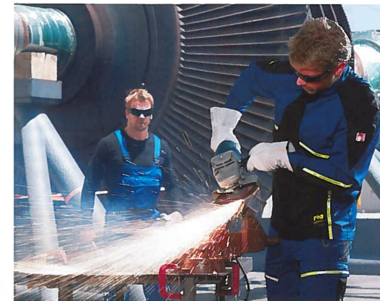
Zum Schutz gegen Hitze und Flammen erfüllen alle Teile der Kollektion die Anforderungen der EN ISO 11612:2008 A1+A2, B1, C1 und E3 und zusätzlich die EN ISO 11611:2007 Kl. 1-A1+A2 speziell für Schweißen und ähnliche Verfahren. Foto: engelbert strauss
