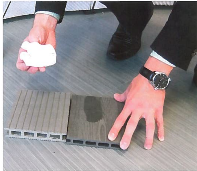
Im Gegensatz zu herkömmlichen Dielen aus Holz, lässt sich Öl von dem Holz-Kunststoff-Material einfach mit einem Tuch abwischen oder mit einem Spülmittel abwaschen. Fotos: UPM ProFi Deck
